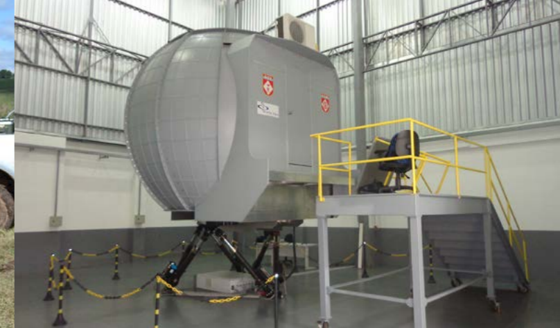
O Simulador de Helicópteros Esquilo e Fennec (SHEFE) atende à formação continuada dos pilotos militares. Pode ser alugado para o treinamento de pilotos civis reduzindo os custos do investimento realizado.
